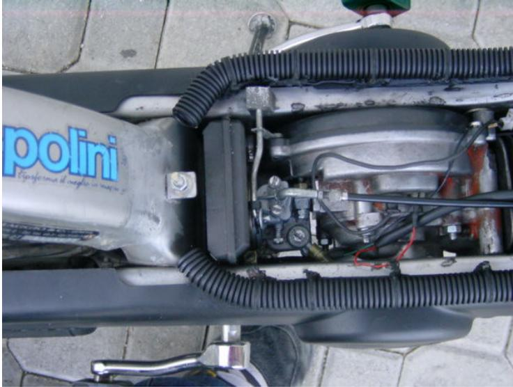
**dopo aver curvato il tubo vediamo se i tubi sono paralleli cioè se hanno le stesse curvature nei stessi punti. Se tutto è a vostro piacimento pitturate le prese e i carter, ricordiamoci di tagliare il tappetino per far sì che i tubi entrino nel vano motore. Dobbiamo inoltre tagliare la leva dell'aria per far sì che ci stiano i tubi e la leva. Una volta pitturato montate il tutto e dovrebbe uscirvi una presa perfetta, la mia è uscita bene**
