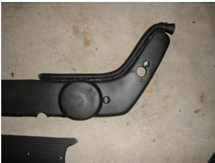
**Sopra possiamo notare come il tubo viene fissato al carter tramite le corde e la colla calda.**
