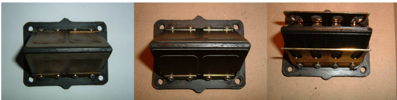
Foto 14 - Lamelle Boyesen a confronto con le monopetalo in carbonio originale della Mito 2
