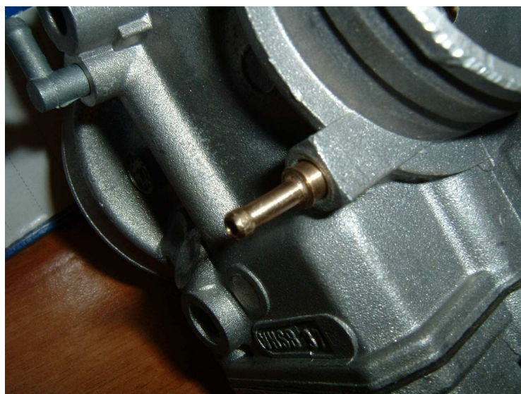
Foto 16- dettaglio dell'adattamento del mio VHSB 37 per l'utilizzo del miscelatore
